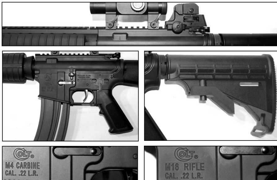
Retrato diseccionado. En este grupo de imágenes podemos ver con más detalle las principales piezas que componen estas carabinas. En la imagen superior vemos el raíl táctico sobre la caja de mecanismos y el sistema de miras abiertas. En las dos fotografías centrales vemos la empuñadura, parte del cargador y la culata telescópica. Por último, un detalle de los grabados con su nombre.
