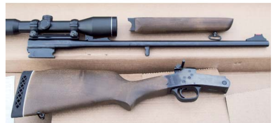
El desarme de este Rossi monotiro es sumamente sencillo. El rifle queda desmontando en apenas 3 piezas: culata, cañón y guardamanos.
