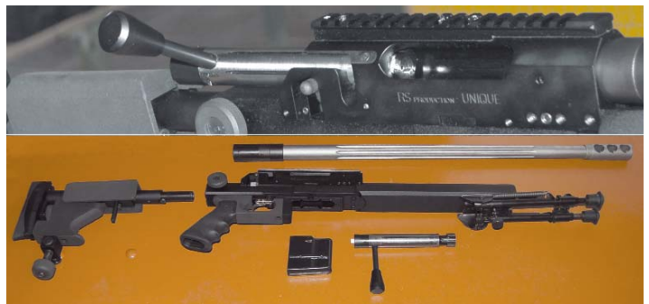
Detalle del cerrojo (arriba) y desarme básico del Unique-FMR Sniper Plus. / armas.es
