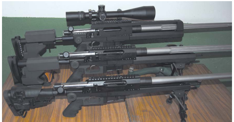
Diversas configuraciones para un mismo rifle. Cañón acanalado, culata ajustable, bípode integrado, etc.
