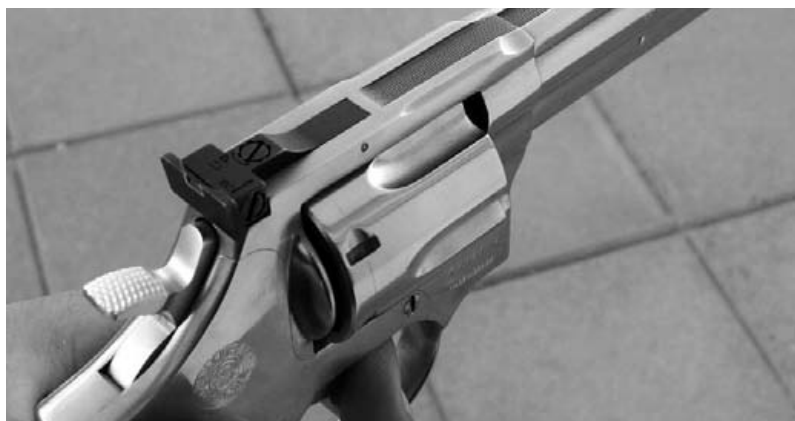
Sistema de miras y banda antirreflejante del revólver Taurus 669 CP en calibre .357 Magnum.
