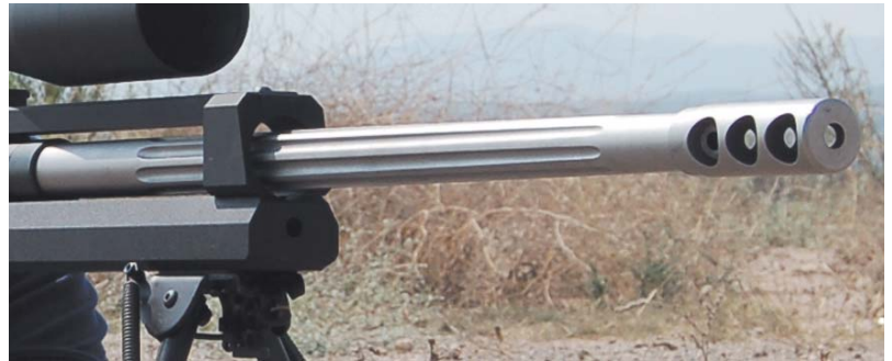
El cañón acanalado y el freno de boca son elementos adicionales que pueden incorporarse a gusto del tirador.
