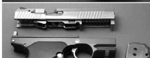
La XR9 se alimenta por detrás de la recámara, lo que permite alargar su cañón.
