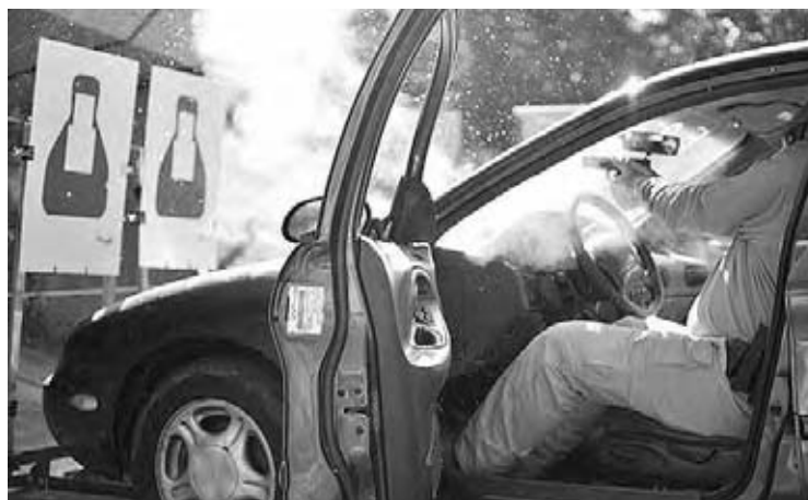
El objetivo de la prueba era comprobar qué proyectiles serían capaces de traspasar la luna, impactar contra un cuerpo, sobrepenetrarlo y alcanzar otro.
