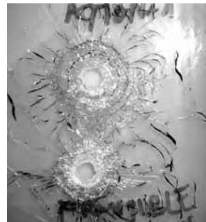
Diversos impactos en el cristal y con las garrafas de agua colocadas justo detrás.
