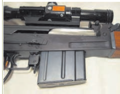
De izquierda a derecha, algunos detalles del Zastava M76: su característico guardamanos con 3 agujeros, su mira de tipo "librillo", su cargador de 10 cartuchos, y su visor Zrak PSO-1.
