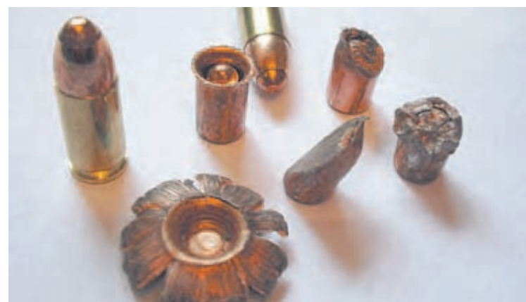
Puntas recuperadas en la prueba. Véanse las diferencias en la deformación.
