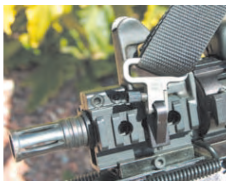
Montura para anclar la correa porta fusil.
