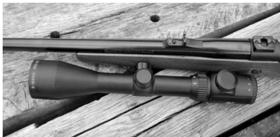
Esta mira óptica dispone de un tubo de 30mm y dos torretas para ajustar en altura y deriva.
