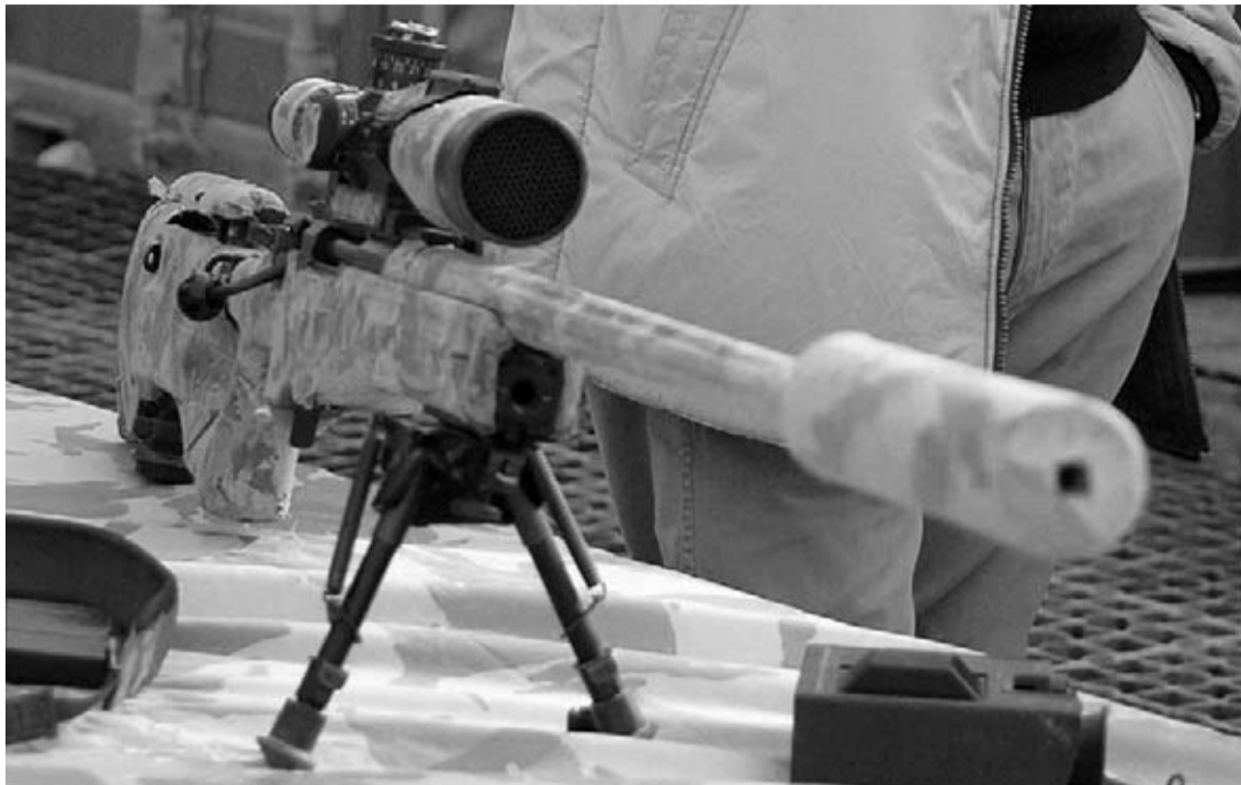
Fusil de cerrojo Accuracy International L115A3 calibre .338 LM de dotación oficial de los sniper británicos.
