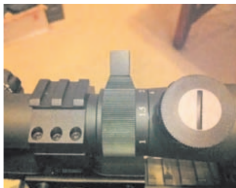
Es muy recomendable adquirir el pin elevador para poder manejar de forma más rápida y sencilla la anilla selectora de los aumentos. Véase en estas imágenes la diferencia con y sin el pin elevador.
