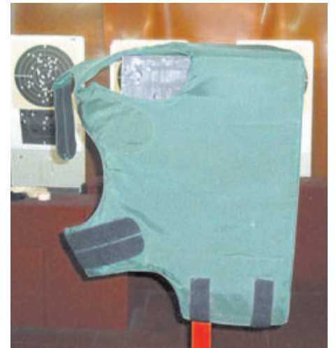
Imagen del antiguo chaleco INDUYCO preparado para ser tiroteado en la galería.
