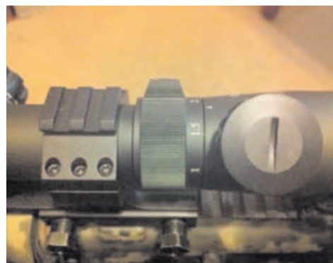
Es muy recomendable adquirir el pin elevador para poder manejar de forma más rápida y sencilla la anilla selectora de los aumentos. Véase en estas imágenes la diferencia con y sin el pin elevador.
