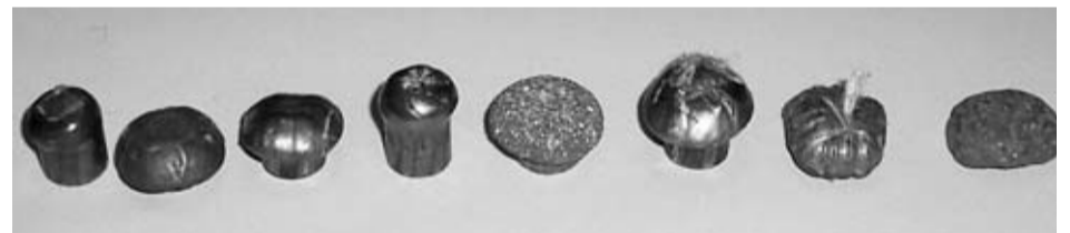
La deformación de estas distintas puntas denota la fuerza de los impactos.
