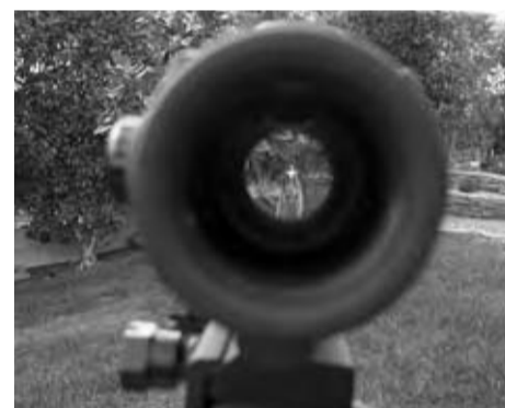
Vista de la retícula iluminada de este visor y que permite disparar con los dos ojos abiertos.
