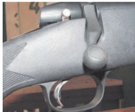
Detalle de la maneta del cerrojo y del disparador Pro-Fire (similar al "Safe Action" de Glock).
