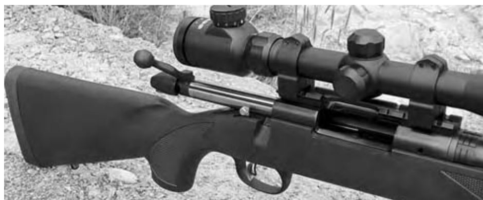
Recámara abierta con la acción del cerrojo acanalada. Véase también el carril Picatinny de serie.
