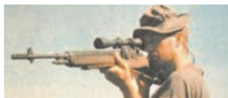
Un soldado estadounidense con un M14 y el visor con calculador balístico Leatherwood ART.
