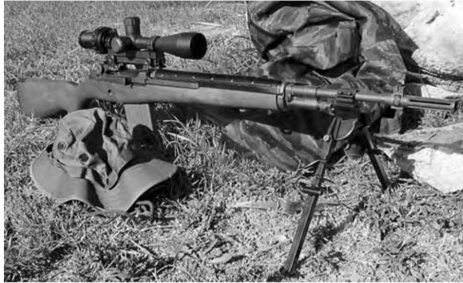
Una combinación de ensueño: fusil M14 en calibre .308 Win con un visor Leatherwood ART M-1000. Este sistema, conocido en su época como XM21 Sniper, sembró el pánico en las filas del Viet Cong.
