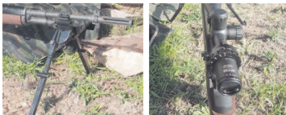
A la izquierda, detalle del cañón del M14 con su característica bocacha apagallamas. A la derecha, primer plano del exclusivo anillo para realizar los ajustes balísticos del visor M-1000 2.5-10x44.
