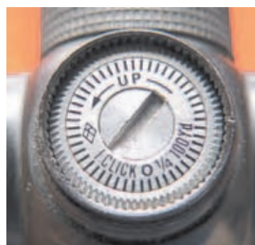
Torreta sin tapas de un visor estándar con los ajustes de corrección en pulgadas. / S. F. Cascante
