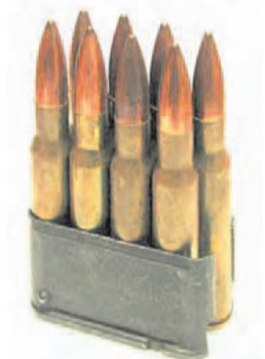
El calibre .30-06 debe su nombre al diámetro de su proyectil (0.30") y al año de su aparición: 1906. Aquí, varios cartuchos en un cargador.
