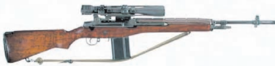
Sistema XM21 Sniper original, compuesto por un M14 mejorado y una mira Leatherwood 3-9x.
