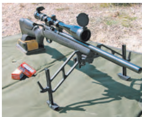
La carabina Sako Quad con cañón pesado (heavy barrel) es una de las más extendidas entre quienes compiten en la División Restricted de la pujante F-Class R. Este modelo en calibre .22LR dispone de culata sintética ergonómica y un disparador que puede afinarse para el tiro de competición.
