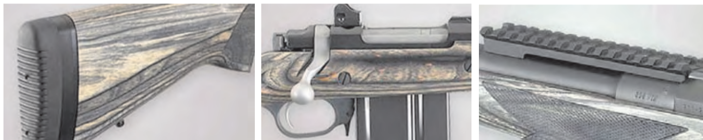
Detalle de la culata y la cantonera regulable. En el centro, imagen de la acción de cerrojo y el conjunto del disparador. Por último, el raíl Picatinny 1913.
