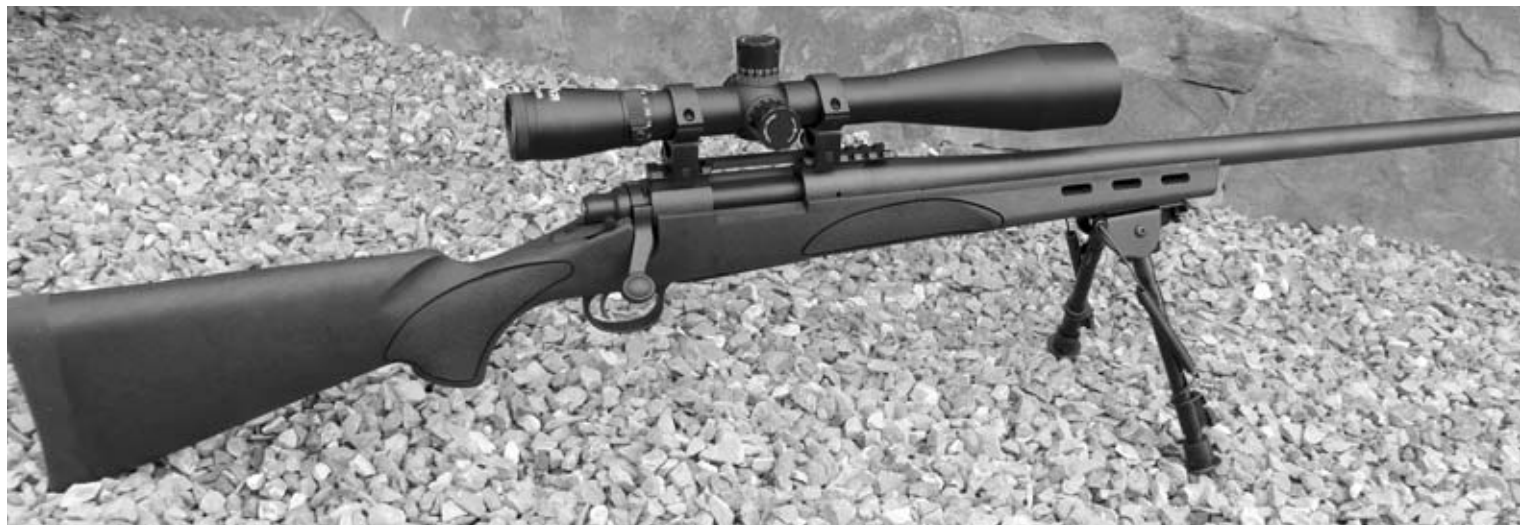
Visor Sun Optics 10-40x50 Mil-Dot montado sobre un rifle de cerrojo Remington 700 y un bípode NcStar. Una combinación perfecta para F-Class R.
