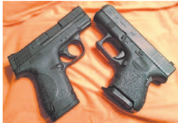
Tanto la Glock 26 como la M&P Shield permiten el uso de cargadores de más capacidad. 7+1 u 8+1 en la pistola de S&W, y 12, 15, 17, 19 y hasta 33 cartuchos en el arma austriaca.
