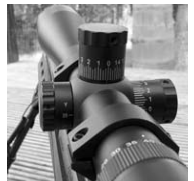
Detalle de las 3 torretas del visor. La de altura y deriva son bloqueables.
