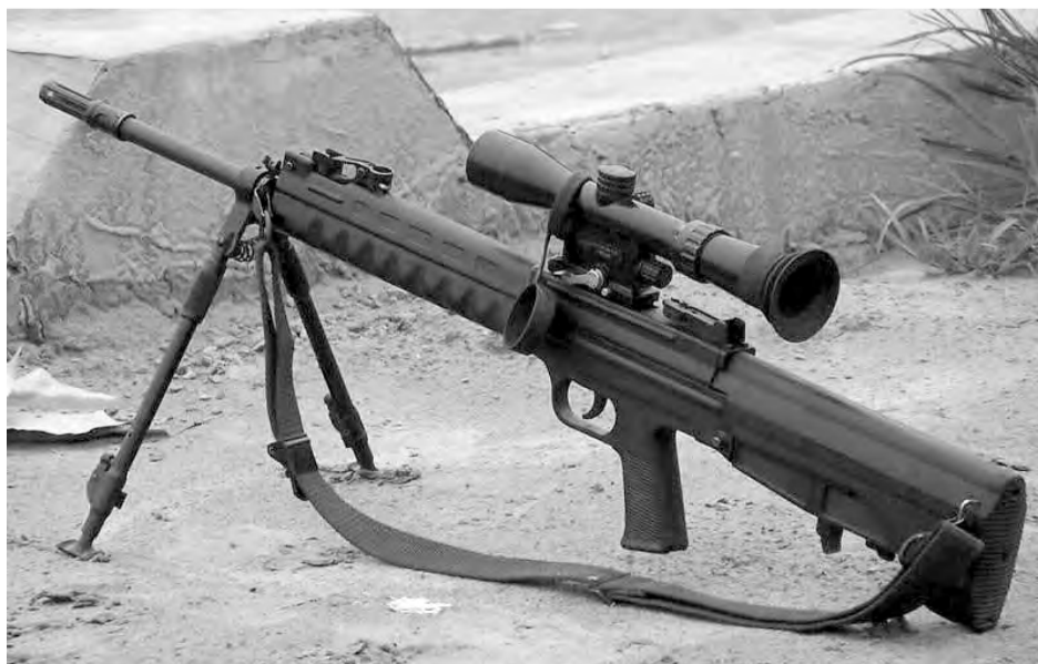
El fusil de asalto QBZ-95 posee una variante destinada principalmente a tiradores selectos, en la que se ha alargado el tamaño del cañón y se ha modificado el diseño de la culata.
