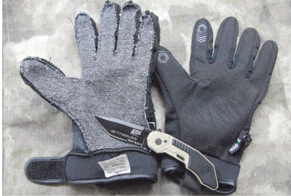
Los guantes SHOKE de neopreno con protección anticorte nivel 5 aguantaron bien las acometidas de la navaja Smith & Wesson M&P, pero cedieron ante el potente filo de la Extrema Ratio BF1.
