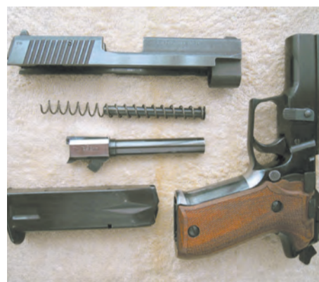
Despiece básico de la Norinco NP-22. Su diseño y rendimiento es acorde a su precio de venta.
