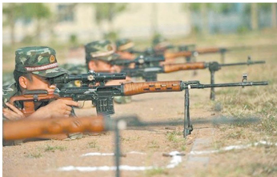
El fusil para tiradores selectos Type 79, y su derivado Type 85, poseen una apariencia exterior prácticamente idéntica a la del clásico Dragunov SVD soviético. Se sirve con un visor de 4x.
