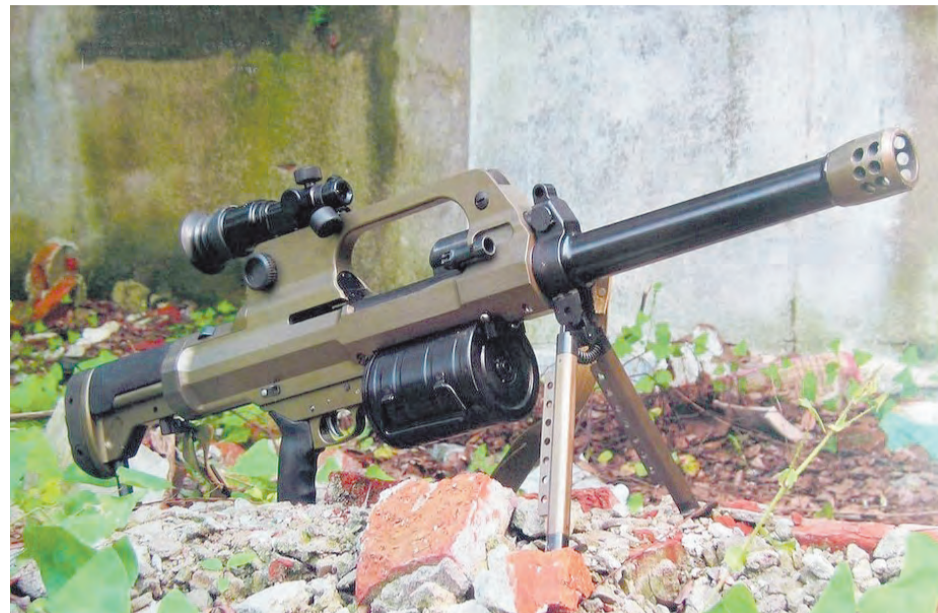
El lanzagranadas semiautomático QLB-06 de 35mm es uno de los últimos y más atractivos desarrollos de la industria armamentística china. Este arma se sirve de dotación con un visor de 3x.
