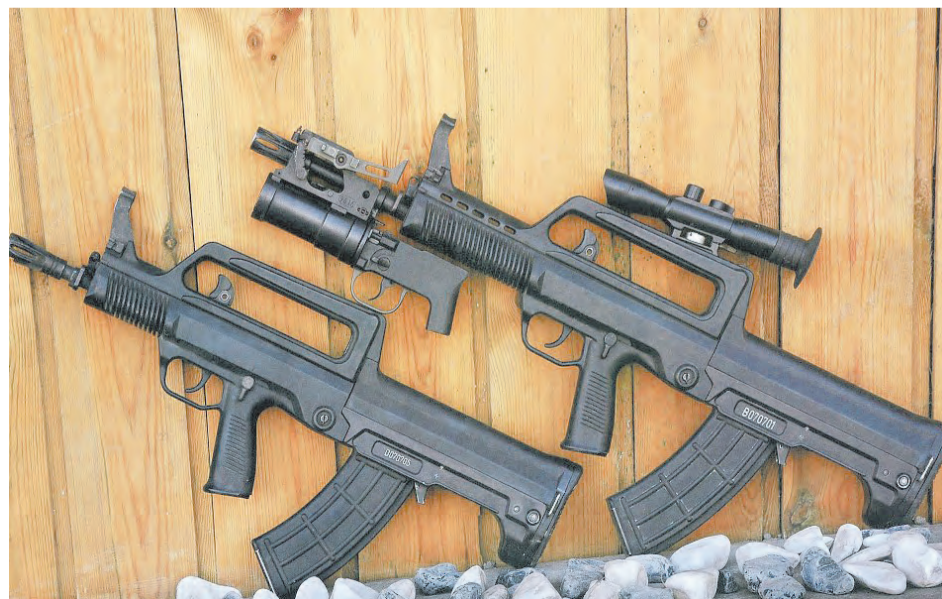
Fusil chino QBZ-95 en sus dos configuraciones básicas. Una de ellas está equipada con un visor sobre su asa de transporte, y un lanzagranadas adosado a su cañón.
