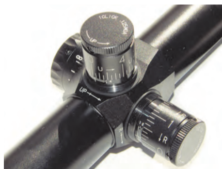
Detalle de las torretas de ajuste del Competition. Corrigen en 1/8 MOA por clic.
