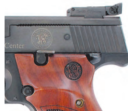
Esta nueva versión también dispone de un alza trasera micrométrica completamente ajustable.
