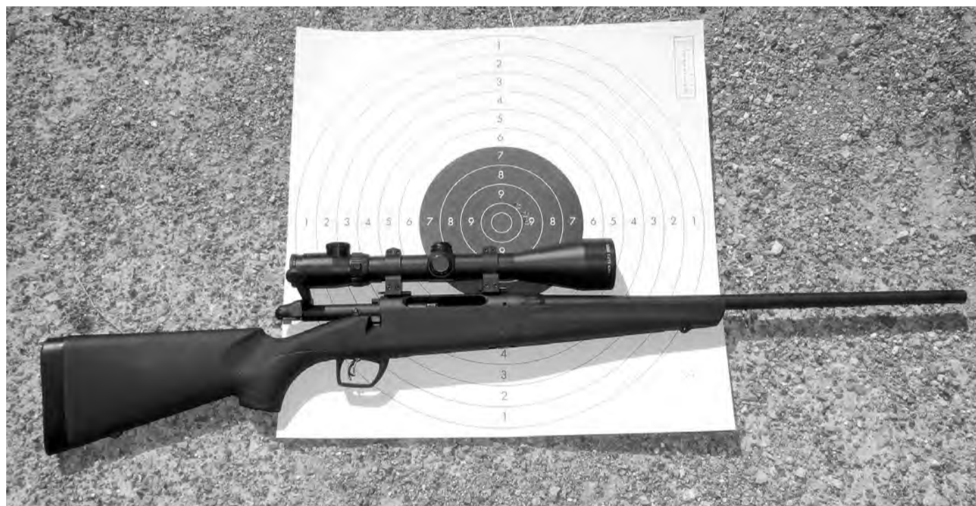
Nuevo rifle Remington 783 con el cerrojo abierto, culata sintética, cañón de 22" y visor Bushnell ELITE 4200 montado sobre unas bases Warne.
