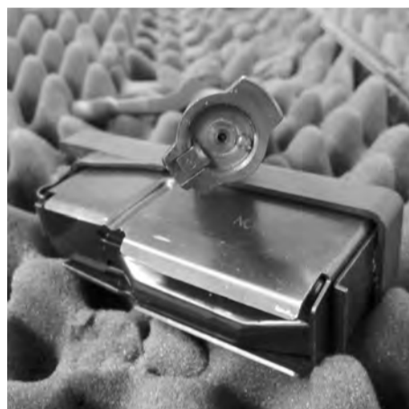
Detalle de la cabeza y la uña extractora del cerrojo, apoyado en el cargador extraíble del 783.
