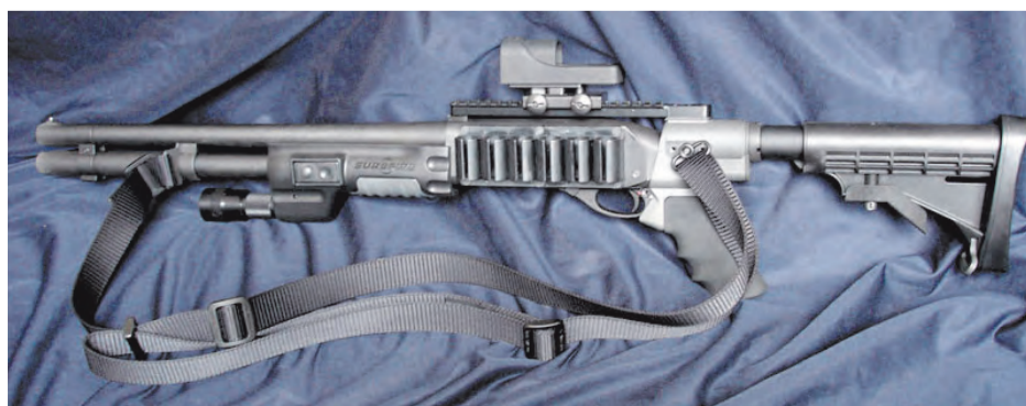
Escopeta de combate con el kit de MESA Tactical incorporado. Sobresalen algunos elementos como la culata telescópica, el módulo de linterna Surefire, y el accesorio portacartuchos.
