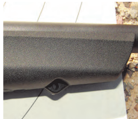
El 783 ha heredado del 770 este erróneo diseño en la culata para colocar una correa portafusil.
