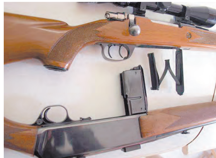
Comparativa de las zonas de carga de dos fusiles de caza. Arriba un modelo de cerrojo tradicional, y abajo un cargador para un rifle semiautomático. En España estos cargadores deben estar limitados a 2+1.
