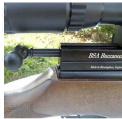
Para accionar el cerrojo de la Buccaneer hay que tirar de él con cierta firmeza.
