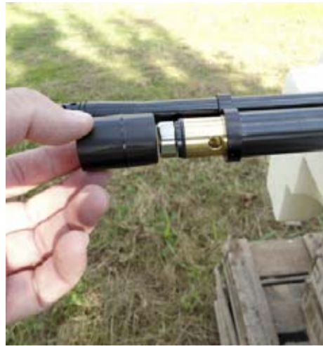
El orificio de carga de aire está protegido por un eficaz capuchón de plástico.
