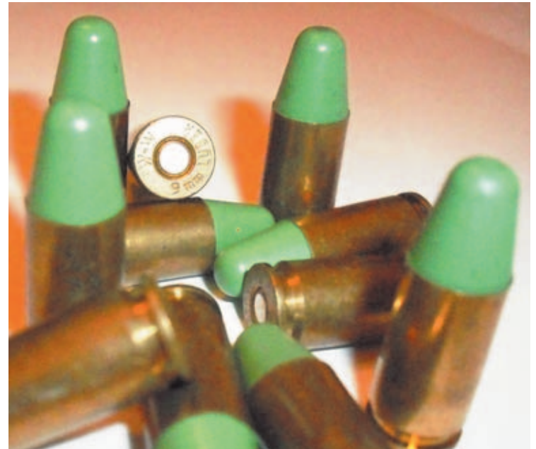
Conjunto de proyectiles KTW también del calibre 9 Luger. Esta punta perforó el chaleco por las dos caras: el pecho y la espalda.
