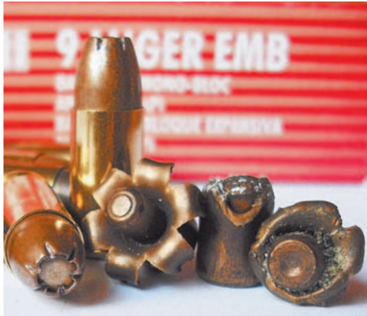
Proyectiles de punta hueca del calibre 9mm Parabellum recuperados tras impactar en las placas del chaleco de protección balística. Véase la importante deformación de las puntas tras el veloz impacto.
