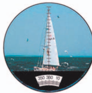
Clásica retícula de unos binoculares con brújula incorporada, con un escalímetro vertical y la medición inferior de los grados.
