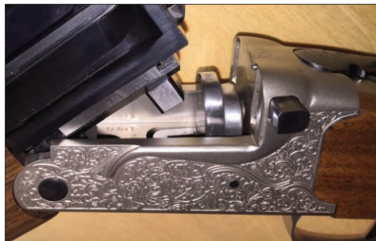
La báscula del monotiro Sabatti SKL 15 con cierre Kersten y pasador Scott
