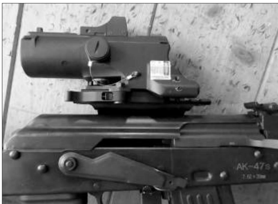
Detalle de instalación en un AK-47, el sistema de anclaje rápido está dotado de seguro
