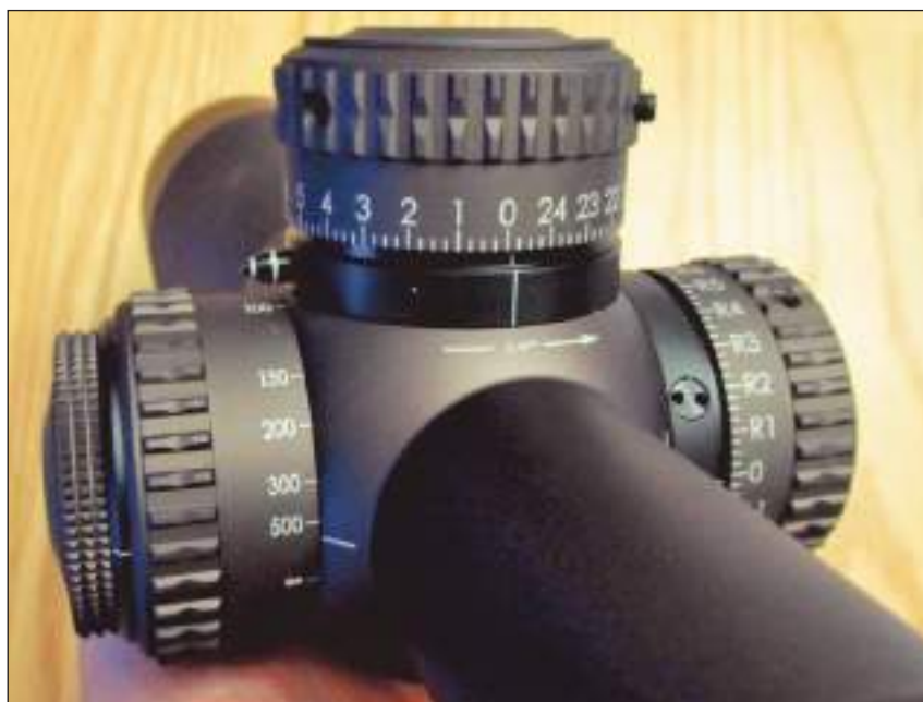
Detalle torretas en fracciones de 0,1 MILIRANDs
