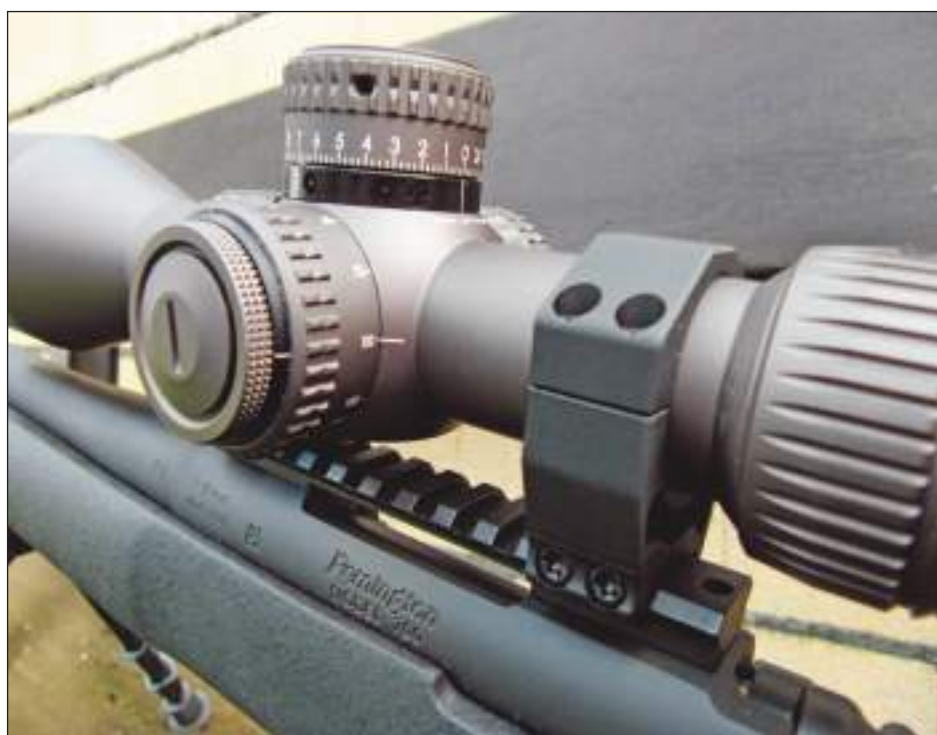
Detalle torreta paralaje e intensidad retícula iluminada
