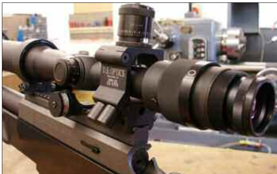
Visor USO-SN09 con chasis de regulación externa. Torreta situado sobre la anilla trasera
