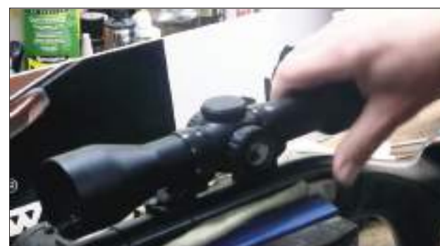
27 – Colocamos el visor. Ya sólo nos faltará colimarlo.
