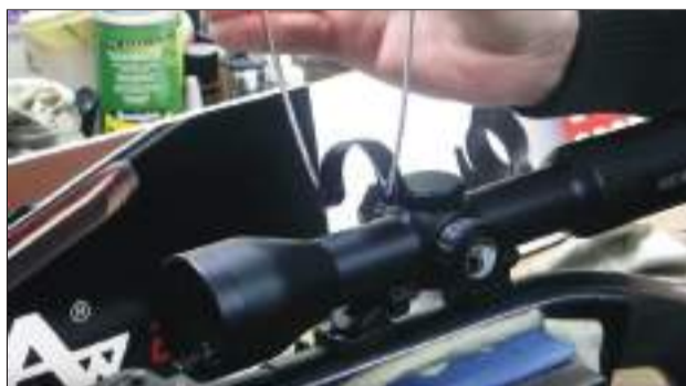
17 – Colocamos suavemente la parte superior de las anillas.
