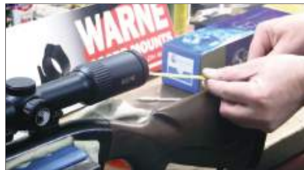
15 - Para 1,75 m de estatura y un cuello normal la distancia del ocular a la bases de la cantonera serán unos 28 cm.
