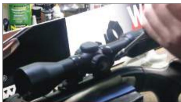
20 – Utilizamos un destornillador dinamométrico con un par de apriete de 2,4 nm para apretar los tornillos de unión de la parte superior e inferior de las anillas. Seguimos una técnica en zig-zag o en X.
