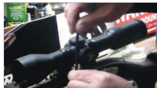
21 – Apretamos los tornillos laterales de la base de las anillas responsables del cabeceo que habíamos aflojado en el paso número ocho.
