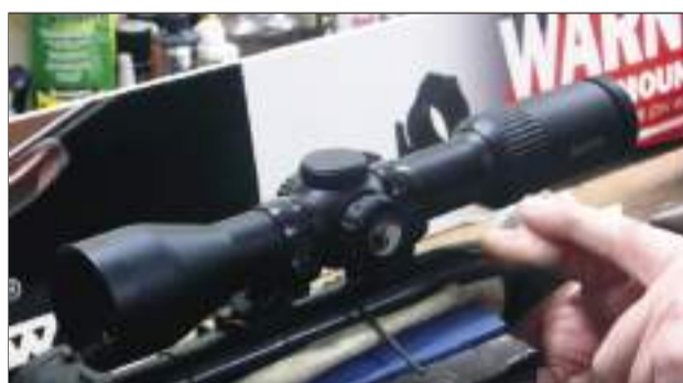
23 – Con dos llaves allen manipulamos la posición del pestillo de seguridad, soltando el prisionero que lo mantiene asegurado y apretándolo en una posición elevada. Posteriormente volvemos a apretar el prisionero para ajustar la nueva posición.
