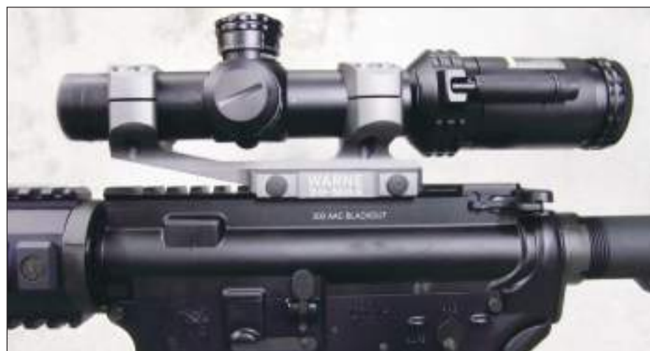
La montura LR-SKEL proporciona una elevación adicional de 20 MOAs
