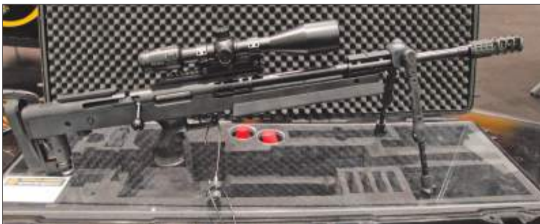
El Keppeler Germany SX-1 MTR es un rifle bullpup caracterizado por su tremenda solidez, para muestra su cerrojo mecanizado de una pieza con siete tetones. Otra de sus características más llamativas es el acerrojamiento solo a 60° y su pistolete ajustable longitudinalmente.
