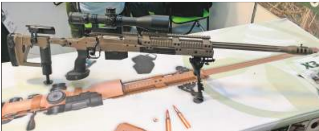
El Voere M2, otro rifle austriaco modular disponible en diferentes calibres. Caracterizado por su rapidísimo y sencillo cambio de cañón en menos de un minuto por el propio operador. Posee un sistema de doble seguro para el transporte.
