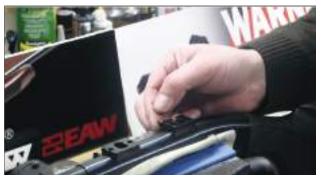
22 – Retiramos el visor y ajustamos el pestillo de seguridad de la base trasera, ya que pueden darse holguras sino lo dejamos ligeramente elevado, que no quede tumbado.
