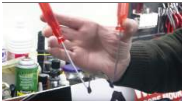
16 – Usamos un pequeño truco mediante dos destornilladores para abrir la parte superior de las anillas y así no tenerlas que meter por presión lo que puede rayar el tubo del visor.
