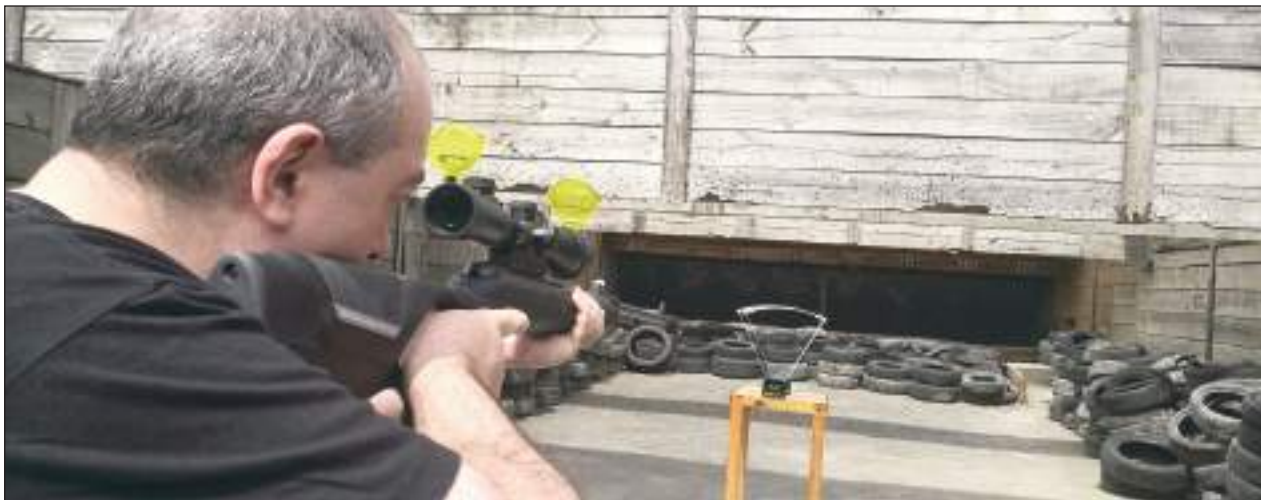
Sometiendo la carabina a la prueba del cronógrafo
