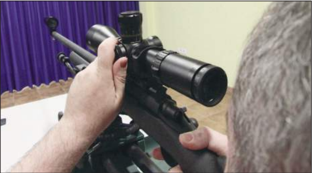
1- El colimador se presenta con cuatro varillas, donde cada una de ellas cubre una gran variedad de calibres. La rueda posterior de cada una de ellas permite el ajuste fino para cada calibre, haciendo que la punta se expanda hasta que esta quede bloqueada en el interior del cañón.
