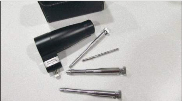
1- El colimador se presenta con cuatro varillas, donde cada una de ellas cubre una gran variedad de calibres. La rueda posterior de cada una de ellas permite el ajuste fino para cada calibre, haciendo que la punta se expanda hasta que esta quede bloqueada en el interior del cañón.
