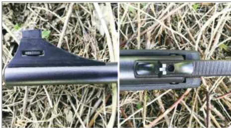
Punto de mira y alza. Estriado anti reflejos en el alza y regulable con tornillo allen
