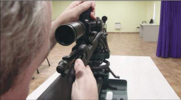
6 – Sin perder de vista la imagen de ajuste manipulamos la torre de altura tantos clicks como sean necesarios para hacer coincidir ambos ejes de abscisas.
