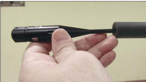
3 – Introducimos el colimador hasta el fondo, comprobando que no haya holguras o que “baile” en el interior del cañón.
