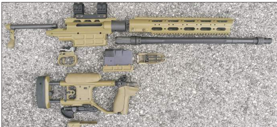
Despiece básico del SAKO TRG M10 donde se puede observar su modularidad
