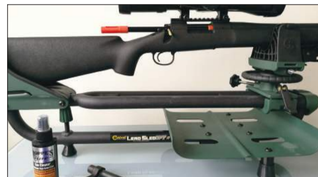
3 - Colocamos una guía universal de baqueta Hoppes (Hoppes Universal Bore Guide) para proteger la acción de posibles roces de la baqueta y gratas de bronce.
