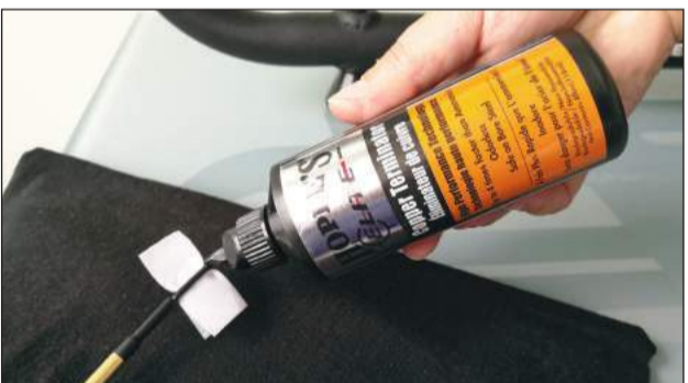
7 - Si el cañón lleva mucho tiempo sin limpiar y le toca una limpieza profunda, repetimos los pasos anteriores (3 - 6) con Hoppes Elite Copper Terminator. Otra opción es realizar la limpieza con este producto desde un principio, pero los mejores resultados se obtienen combinándolos.
