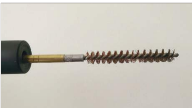
5 - Pasamos una grata de bronce 10 veces (cinco de ida y cinco de vuelta) para desincrustar la suciedad. Si llevamos una rutina de limpieza de cañón habitual u ordenada, podemos sustituir la grata de bronce por una de nylon en limpiezas alternas.
