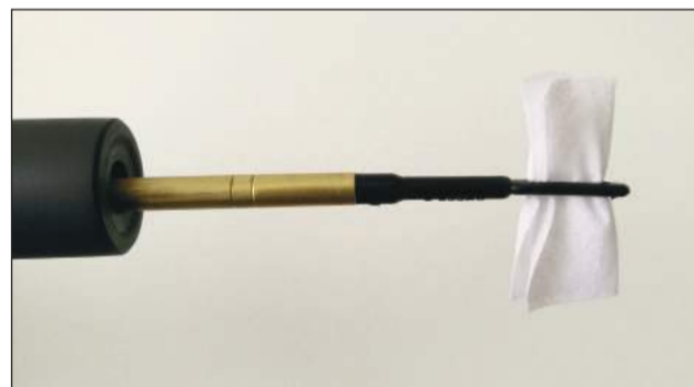
9 - Para el fabricante del producto el tratamiento termina en el paso anterior. Personalmente recomiendo pasar un parche limpio para asegurarnos que lo que hemos dejado es sólo una película protectora, eliminando el exceso de aceite.
