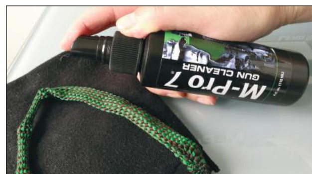
3 - Impregnamos la zona de limpieza de la BoreSnake, delante de la zona del cepillo de bronce, con M-Pro 7 Gun Cleaner por una cara.
