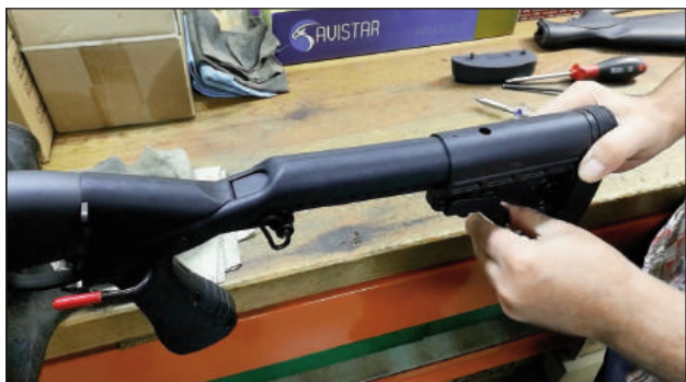
13 - Colocamos de nuevo la culata en el tubo, para ello realizamos la maniobra inversa a la realizada en el paso número dos.
