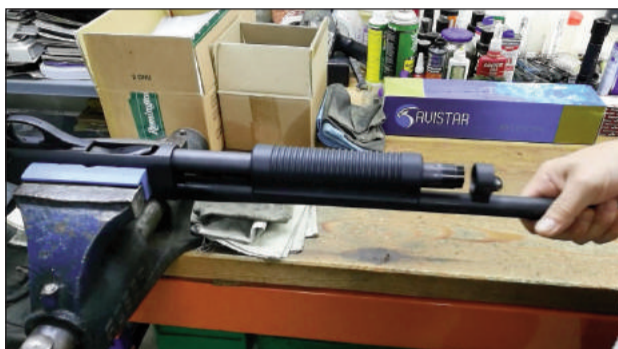
2 - Retiramos el cañón del armazón tirando simplemente hacia afuera.
