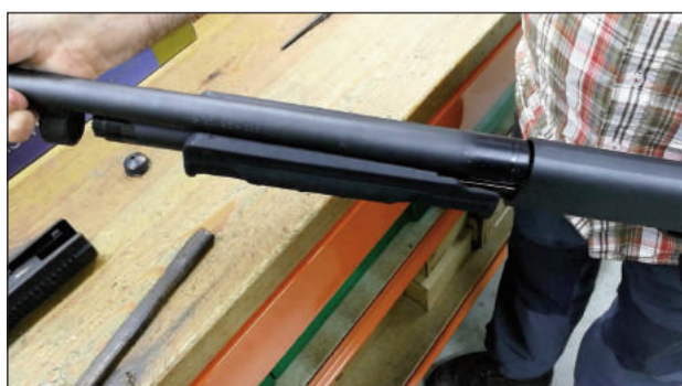
11 - Colocamos el cañón y lo aseguramos con el tapón del guardamanos.
