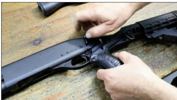
14 - Ya podemos retirar el pasador de seguridad que mantiene la tensión de los muelles anti-retroceso de pistolete y culata. Colocamos la marca roja a las 12 en punto, girándolo en sentido de las agujas del reloj y tiramos hacia fuera para su extracción.
