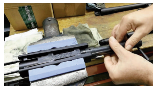
6 - Colocamos el guardamanos en el tornillo de mesa para soltar la tuerca de sujeción con una llave de tubo específica.
