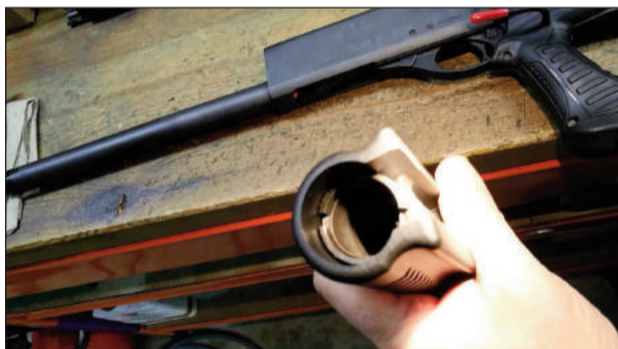
5 - El guardamanos se sustenta sobre un tubo al que permanece unido a través de una tuerca.
