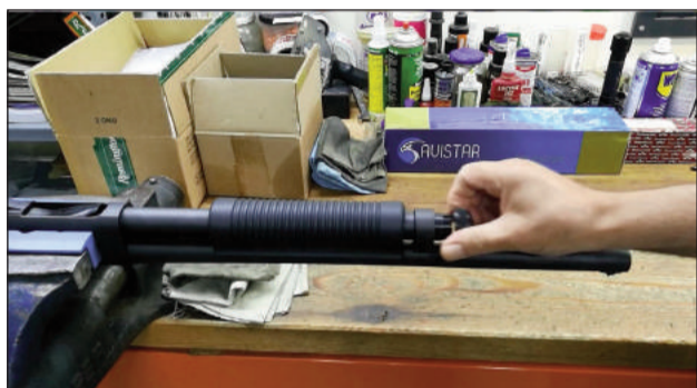
1 - Colocamos la escopeta en posición invertida en el tornillo de mesa para trabajar más cómodamente. Desenroscamos con la mano el tapón del extremo del depósito tubular de munición.
