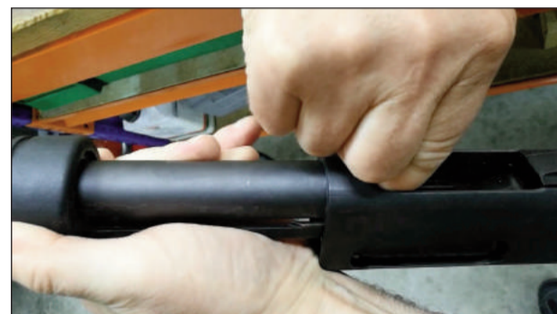
3 - Para poder retirar el guardamanos con el mecanismo de corredera, necesitamos presionar los seguros de cada guía. Estos están situados a ambos lados del armazón, en el interior de la ventana de carga. Simultáneamente a esta operación tiramos del guardamanos.
