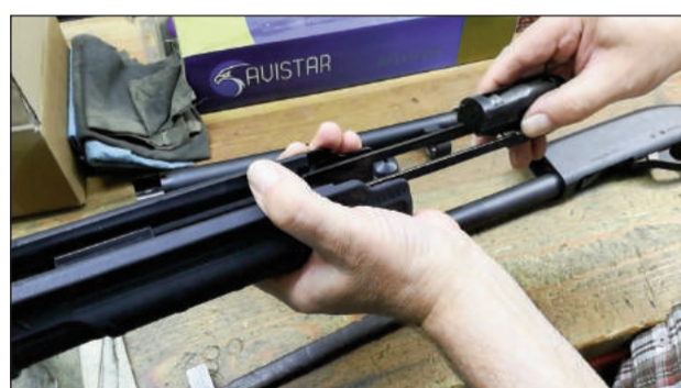
9 - Colocamos el cerrojo sobre las guías del guardamanos en la misma posición que cuando lo extrajimos.
