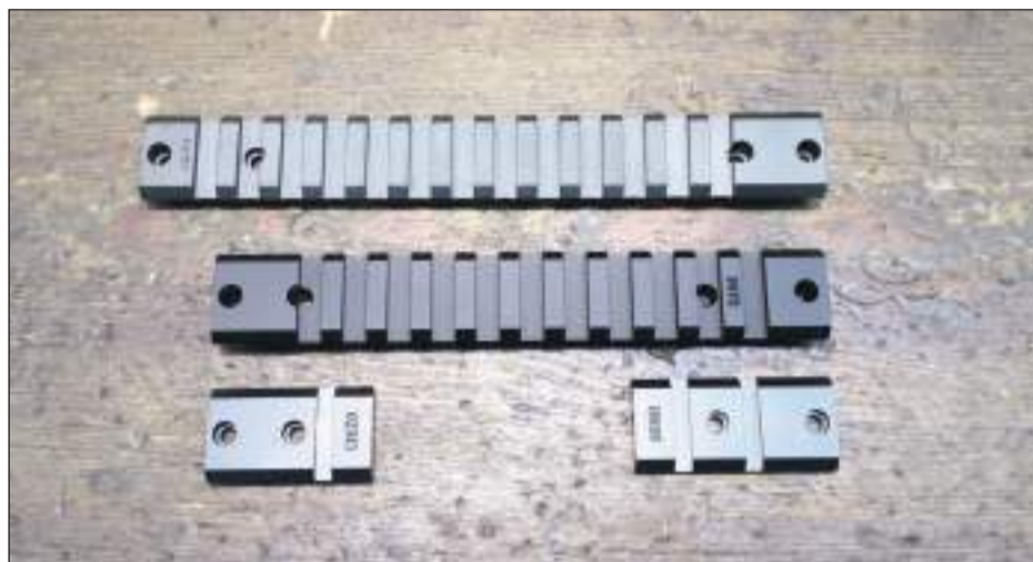
Bases Picatinny en acero y aluminio. Base "partida" Weaver. Todas de la casa WARNE.
