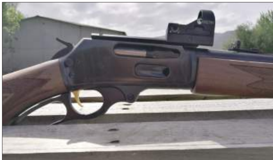
Vista de las ventanas de expulsión y carga lateral. Esto permite la colocación de una óptica
