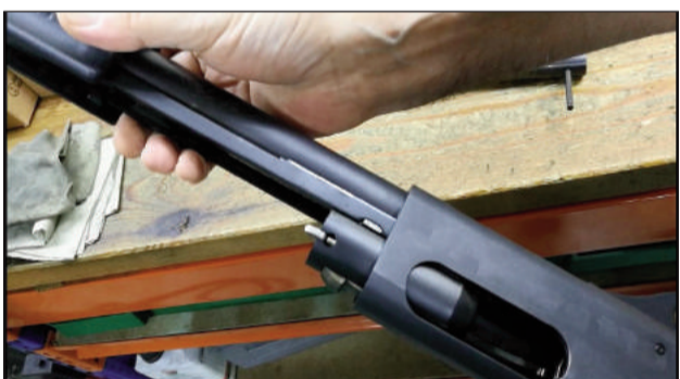
4 - Mientras tiramos hacia fuera del mismo, deslizando por el depósito tubular, veremos que a la vez también extraemos el cerrojo.
