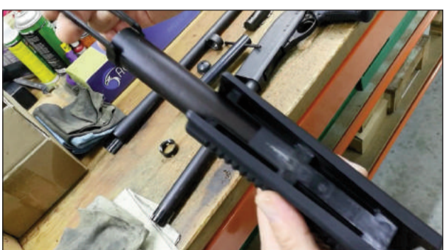
7 - Separamos el tubo portador y el guardamanos simplemente tirando del mismo.
