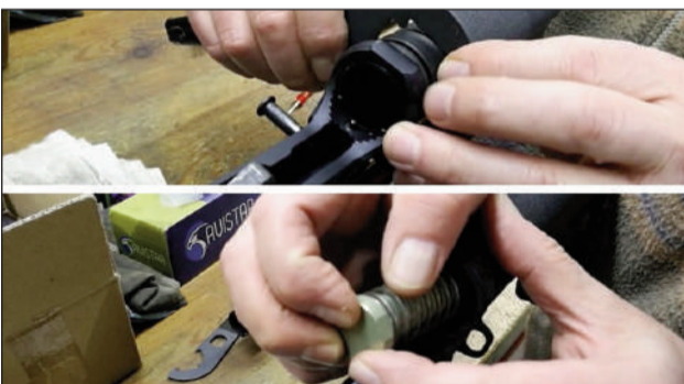
8 – Apretamos la tuerca que asegura la culata al "lower". Introducimos de nuevo el muelle y el "buffer" salvando el bulón que los mantiene en su sitio.
