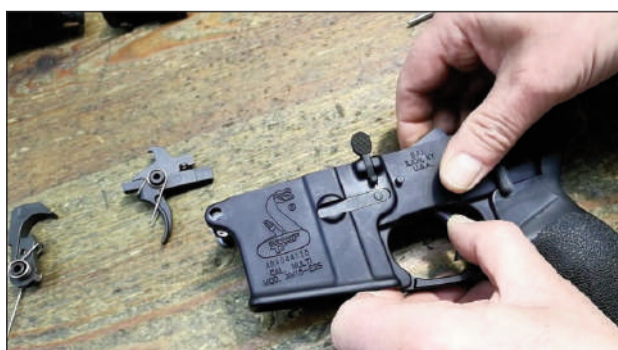
8 – Colocamos los dos pasadores que los sujetan.
