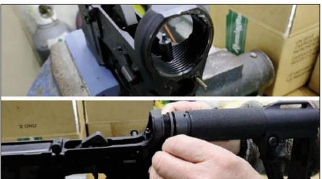
7 – Roscamos la nueva culata en el "lower", teniendo cuidado de colocarla correctamente con respecto al pequeño bulón que mantiene el "buffer" sujeto y la placa metálica que retiene el muelle del pasador trasero del "lower".
