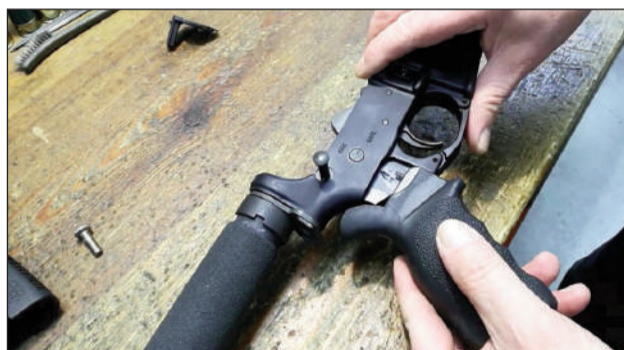
7 – Colocamos la catcha en el "lower".
