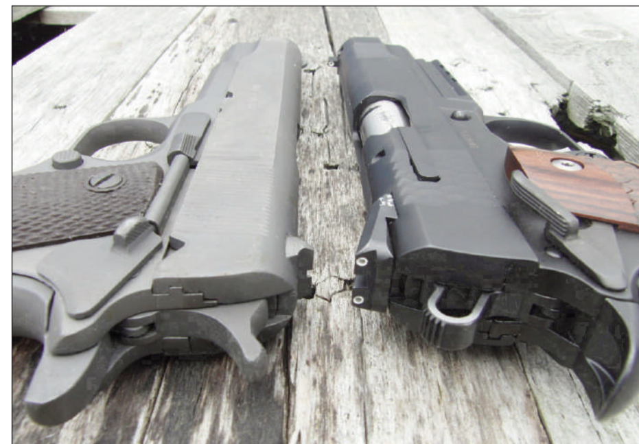
Seguros ambidiestros y sobredimensionados en el caso de la S&W
