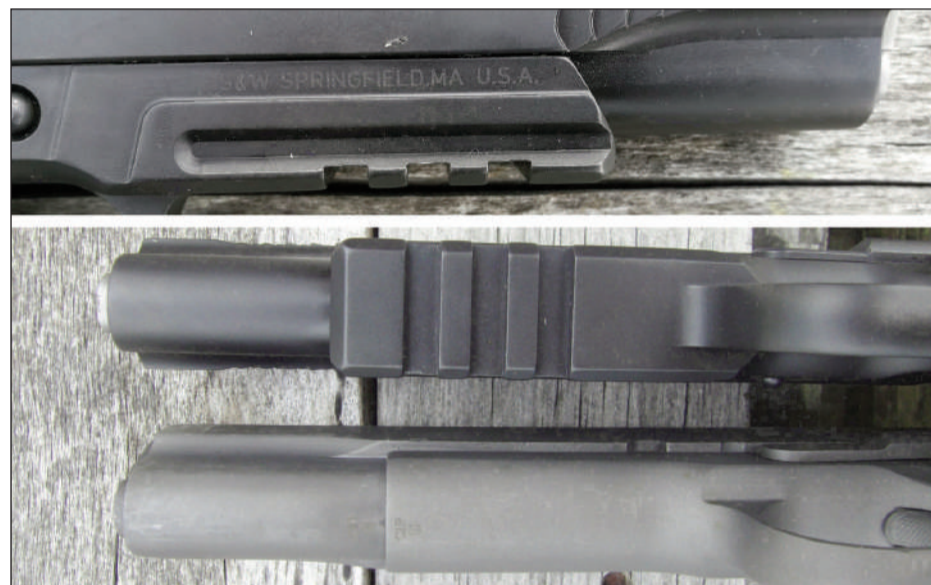
Detalle del riel picatinny en la moderna S&W
