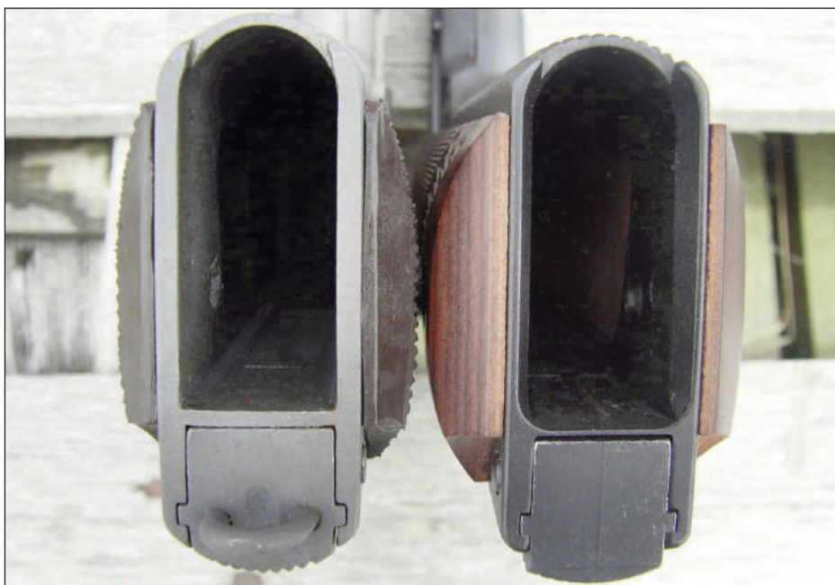
La boca en la S&W está biselada internamente para ayudar en la recarga
