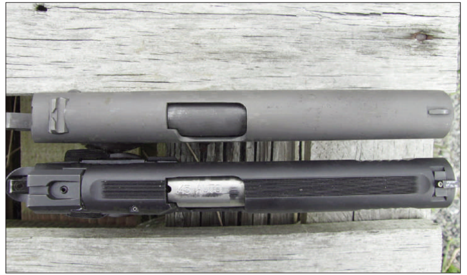
La corredera de la S&W presenta un fino estriado para evitar reflejos y unas miras regulables
