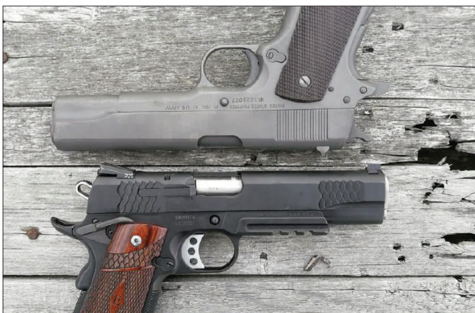
La calidad de los aceros modernos han permitido ventanas de expulsión sobredimensionadas
