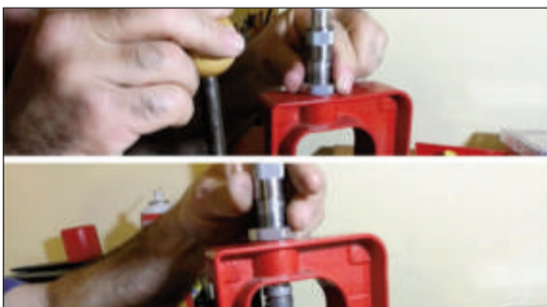
22 – Instalamos el die que se encarga de asentar el proyectil. Al igual que en el caso del die de desempistonado, dejamos un milímetro de distancia entre el recorrido máximo del émbolo y la base de dicho die.
