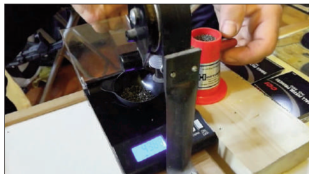
20 – El proceso es notablemente más lento, ya que el dispensador manual no suele ser tan preciso, por lo que hay que acabar la carga con el graneador.
