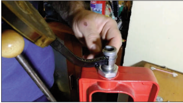
14 – Lo instalamos en la prensa. Resulta algo más complejo que el empistonador manual, que nos permite realizar la tarea más cómodamente, de forma independiente de la prensa.
