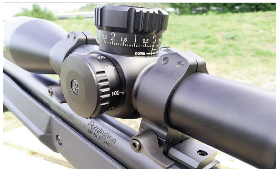
El control de paralaje tiene varias distancias predefinidas
