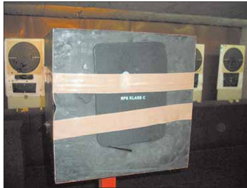
Plancha Balística de refuerzo de la firma Active Armour, objeto de la prueba.
