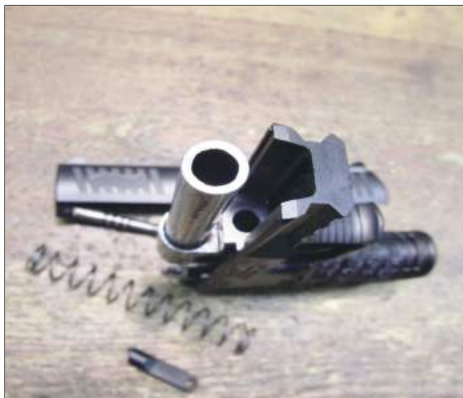
Vista en detalle del cañón y debajo el cilindro donde se inserta el pistón anclado a la corredera
