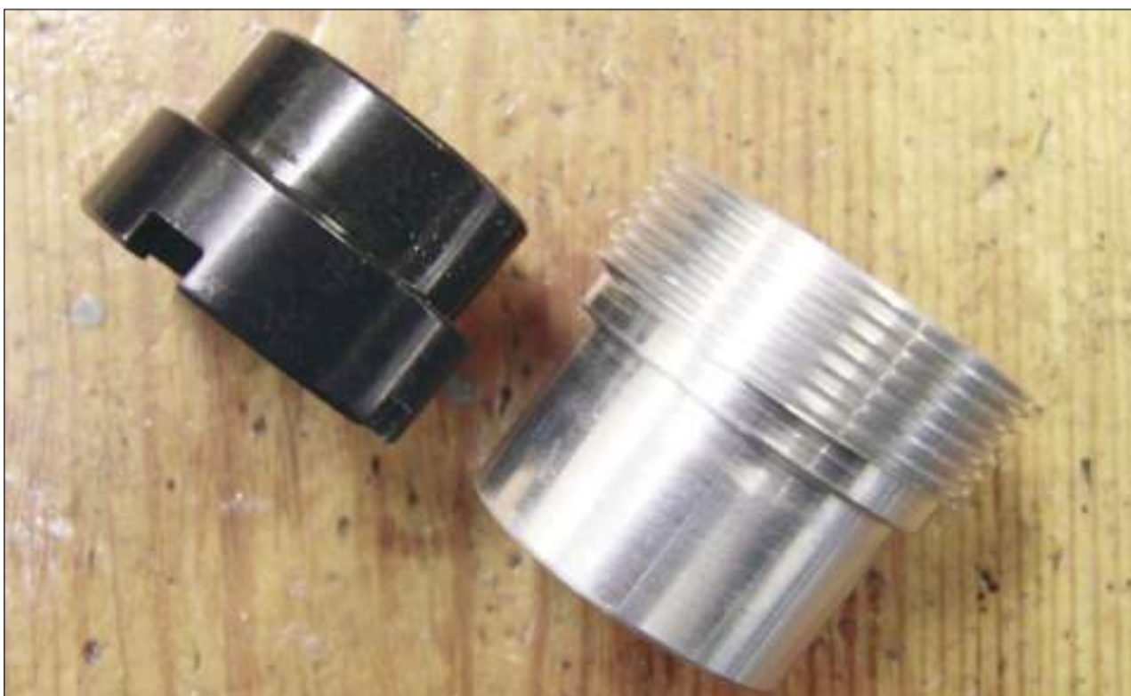
En negro la tuerca original, en plata la elaborada a medida por Armería CASA PUNTOS
