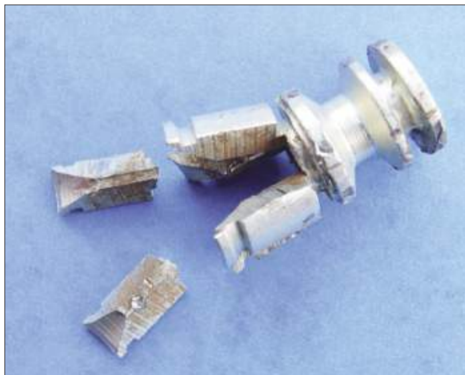
Las cuchillas poliédricas cortan en todas sus aristas y se desprenden fácilmente
