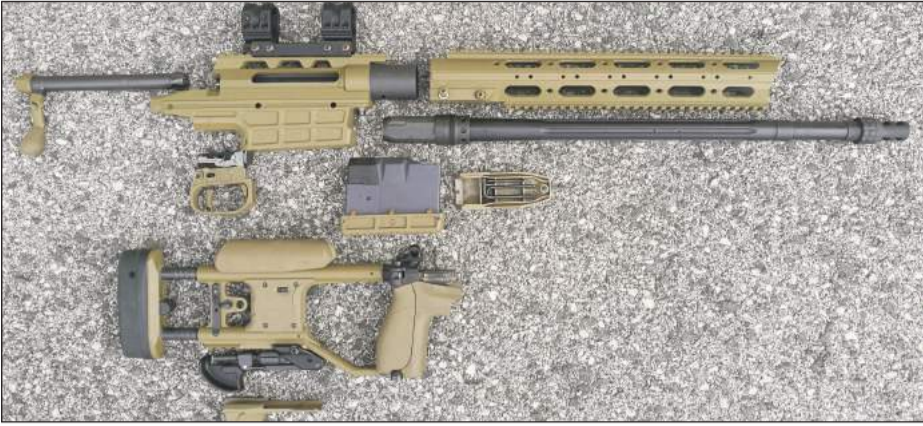
Despiece básico del SAKO TRG M10 donde se puede observar su modularidad
