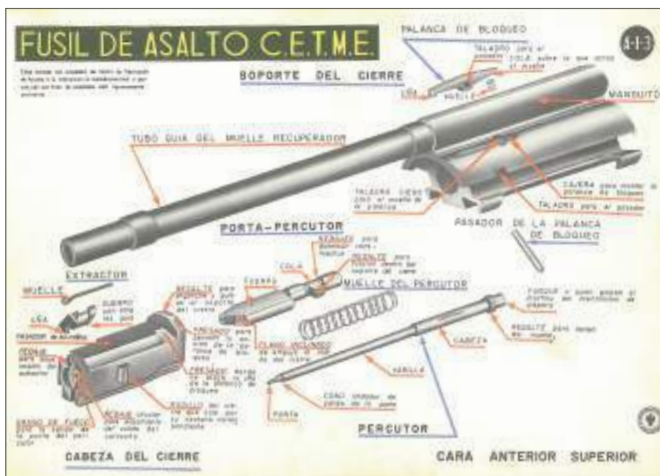
Partes sistema de cierre. Gráfico gentileza de los hermanos HERRANZ de LA MADRIGUERA.
